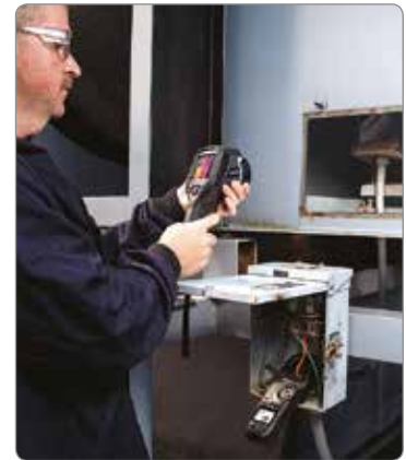
FLIR CM78 überträgt elektrische Messungen in Echtzeit über METERLiNK an FLIR Wärmebildkameras
