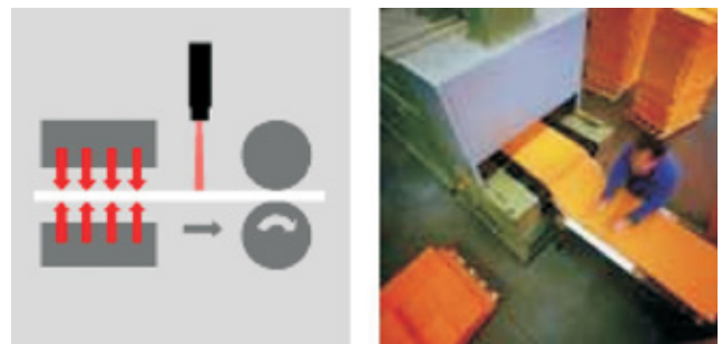
Infrarottemperaturmessung bei der Papier- und Kartonherstellung
