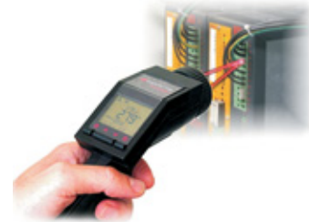
Detaillierte Infrarottemperaturmessung an einer elektrischen Steuerung mit Hilfe der eingebauten Scharfpunktoptik des optris LS im 1 Millimeterbereich
