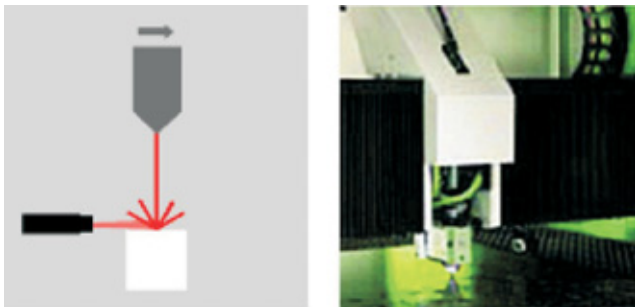
Infrarottemperaturmessung beim Laserschweißen
