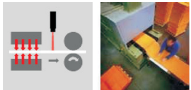
Infrarottemperaturmessung bei der Papier- und Kartonherstellung
