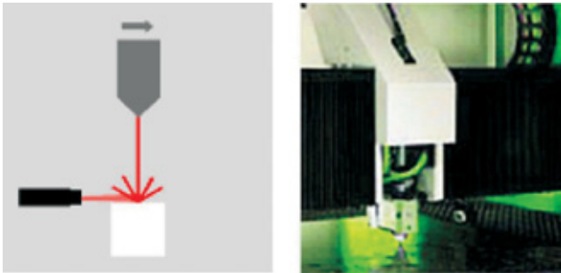
Infrarottemperaturmessung beim Laserschweißen
