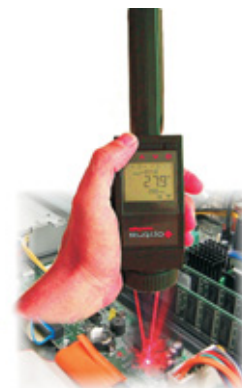
Hochgenaue Infrarottemperaturmessung mit dem optris LS an nur 1 mm kleinen SMD-Bauelementen beim Leiterplatten-Testlauf
