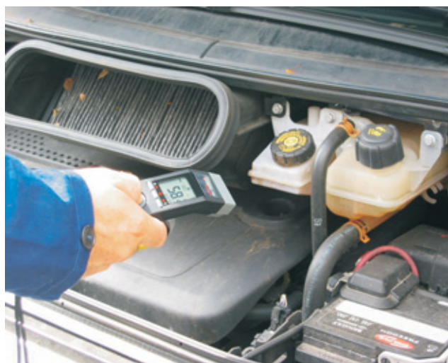
Überprüfen des Heizungssystems
