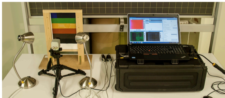
Messgerät Tracer während der Untersuchung eines Probekörpers. (Bild: Cornelius Palmbach)
