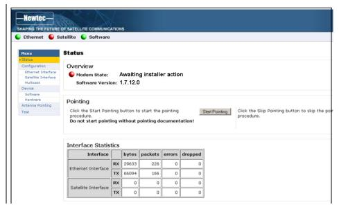
5 Klicken Sie auf die Schaltfläche Start Pointing. Sie können jetzt mit der Ausrichtung der Antenne beginnen.
