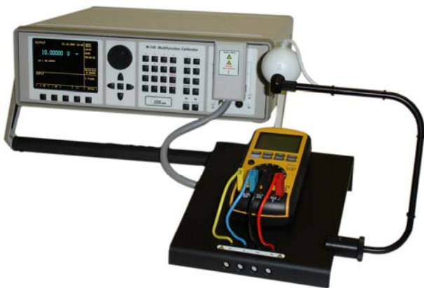
Automatische Kalibration von Multimetern mit Digitalkamera und WinQbase Software.
