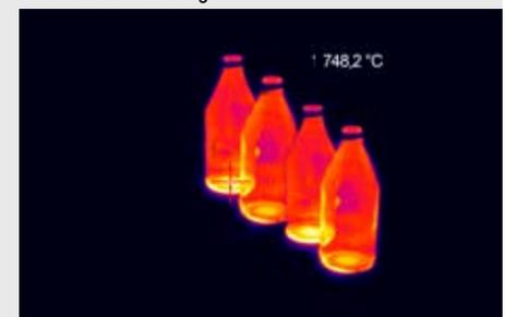
Hot-Spot-Messung bei der Herstellung von Glasflaschen
