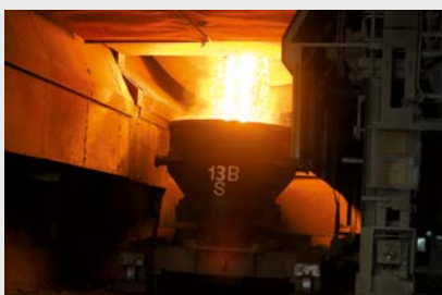
Kontrolle der Ausmauerung von Schlackewagen beim Herausfahren aus der Halle
