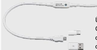
Über den IR-App-Connector kann das CSmicro mit dem Smartphone verbunden werden
