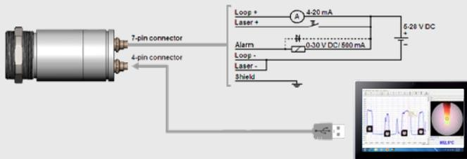
Analoge Betriebsart: 4-20 mA und Alarmausgang. Setup & Ausrichtung über USB-Kabel (hot Plug & Play)
