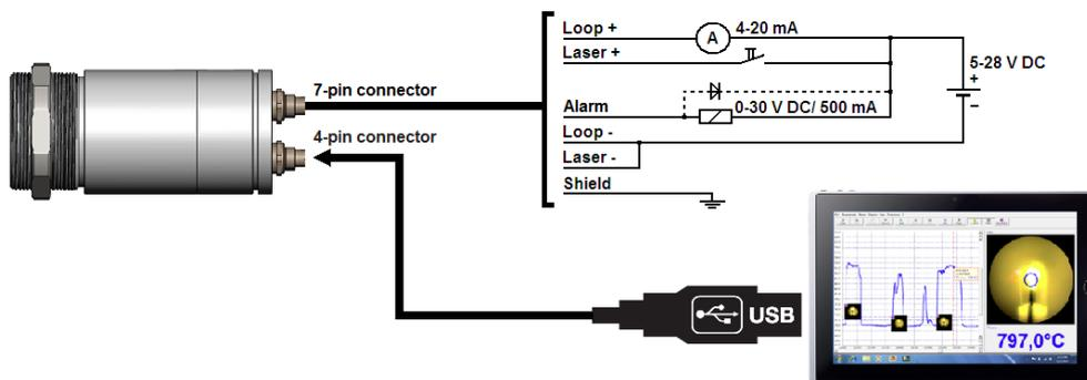
Digitale Betriebsart: Prozessüberwachung (Video und Temperatur) über Software
