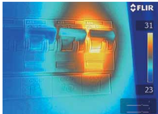
Infrarotbild der gleichen Sicherung mit der MSX-Funktion. Sogar die Schilder sind sichtbar, was auch den späteren Austausch der richtigen Komponente sicherstellt.
