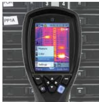
FLIR i3, Temperatur an 3600 Punkten
