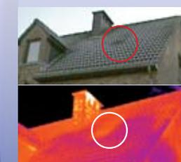
Dank der Inspektion mittels Infrarottechnologie kann die mangelnde Isolierung des Daches erkannt und repariert werden. So geht keine Energie mehr verloren.
