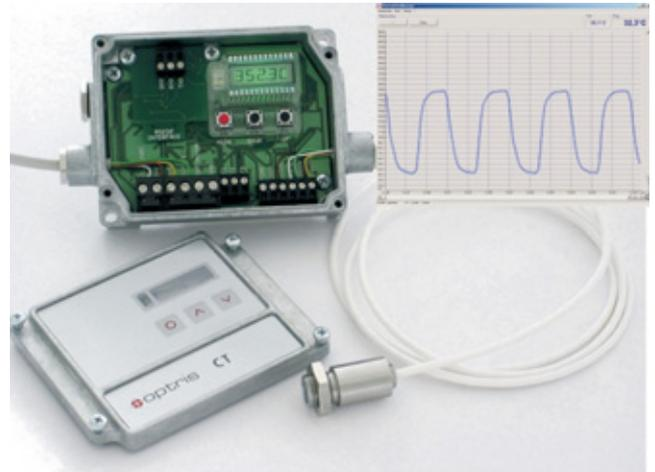
Die Datenausgänge von Infrarotthermometern können direkt an PC, Laptop, Messwertschreiber oder Drucker angeschlossen werden. Mit PC-Software lassen sich kundenspezifische Grafiken und Tabellen erstellen.
