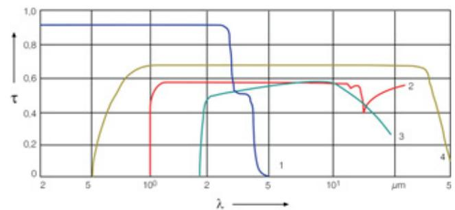
Transmission typischer Infrarotmaterialien (1 mm dick)
