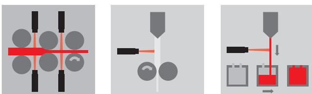
**Typische Anwendungen für stationäre Infrarotthermometer**
