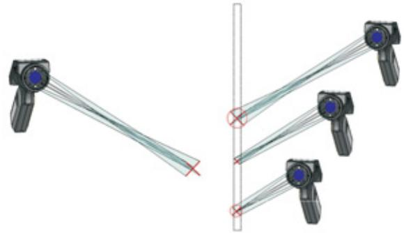
Infrarotthermometer mit Kreuzlaservisier zur exakten Messfeldmarkierung
