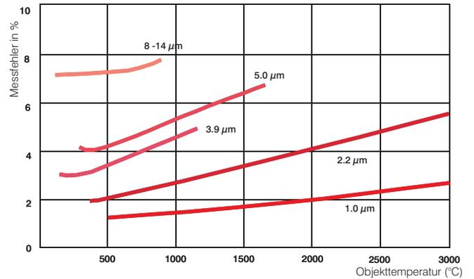
Messfehler bei 10 % falsch eingestelltem Emissionsgrad in Abhängigkeit von der Wellenlänge und Objekttemperatur.
