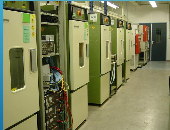
Mehrere Klimaschränke zur Bauteilekontrolle werden von nur einem Messrechner überwacht (Holland)
