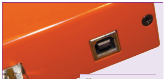
USB Typ B Buchse/Stecker - am USB-Gerät (hier z. B. MEphisto Scope)
