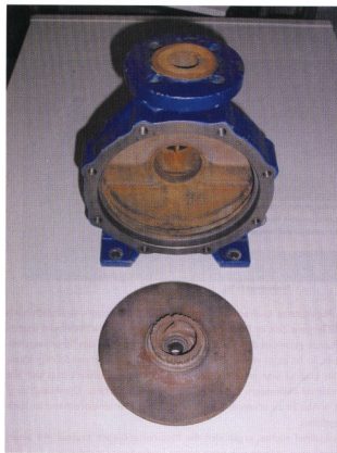
Abb. 3 Abnutzung von Laufrad und Gehäuse durch Kavitation, am Spiralgehäuseaustritt ist das Spornprofil ausgebrochen, an der Ablassschraube sind Auswaschungen sichtbar und Kavitationsschäden führten zur Spaltweitenvergrößerung zwischen Laufrad und Gehäuse
