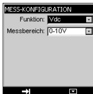
Gehen Sie im Menü **KONFIGURATION MESSUNG** auf das Feld **Funktion** mittels der Taste **F1**.
