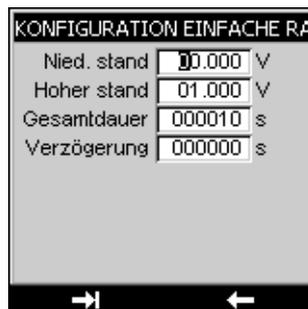
Der Zugang zum Menü **KONFIGURATION/RAMPE** erfolgt mittels der Taste **F2**. Achtung! Es ist unerlässlich, den angemessenen Funktionsmodus programmiert zu haben (Modus **INKREMENTE**), um in das Menü **KONFIGURATION/RAMPE/EINFACH** zu gelangen.
