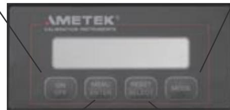
Die MENU/ENTER Taste beinhaltet intelligente Prompts, welche den Benutzer durch das Setup und die Bedienungen führen. Die Taste erlaubt dem Benutzer die Einheiten, Auflösung, Sensor-ID und Koeffizienten zu spezifizieren.
