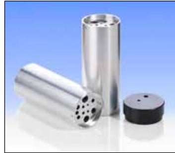
Diese Einsatzhülsen verfügen über Bohrungen für den DLC-Sensor und zwei Referenzsensoren (4 mm und 1/4"). Diese Bohrungen sind zur Erleichterung des Anwenders markiert.
