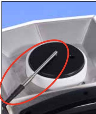
Der neue STS-200 Referenzsensor und der DLC-Sensor verfügen über ein spezielles Design. Beide haben einen Winkel von 90 Grad und sind maßgefertigt, sodass diese lediglich geringfügiger höher sind als die Oberkante des RTC-Kalibrators.
