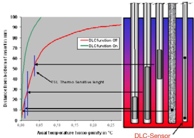
Axiale Temperaturkurven für einen RTC-Kalibrator mit und ohne der aktivierten DLC-Funktionalität. Die DLC-Steuerung wird automatisch deaktiviert, wenn die Mischereinheit gestartet wird.
